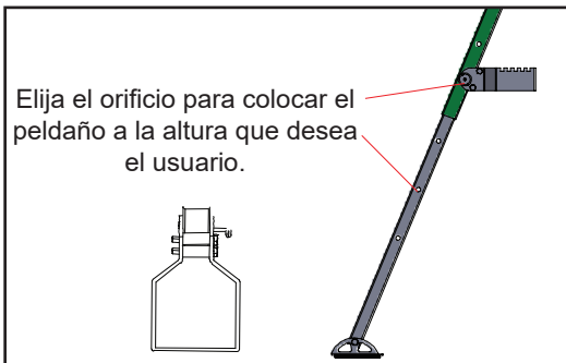
FIGURA 21: INSTALACIÓN DE LOS PELDAÑOS PARA TRÍPODE
