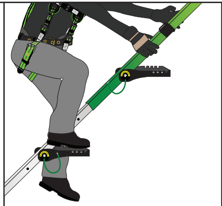
FIGURA 21: INSTALACIÓN DE LOS PELDAÑOS PARA TRÍPODE
