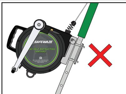
**Nota:** No monte el dispositivo en la manga interior de la pata del trípode
