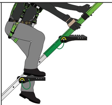
**FIGURA 21: INSTALACIÓN DE LOS PELDAÑOS PARA TRÍPODE**
