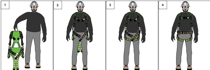
Una vez abrochadas las correas de las piernas, el cinturón (si corresponde) y la correa del pecho, utilice los ajustadores para apretar o aflojar el arnés hasta lograr un ajuste ceñido. El arnés debe permitir un rango completo de movimiento. **Nota:** Pase cualquier exceso de cinta de la correa a través de los sujetadores elásticos o de plástico.
