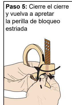
FIGURA 9 - INSTALACIÓN Y FUNCIONAMIENTO DEL AGARRADOR DE CUERDA DE EXTREMO LIBRE
