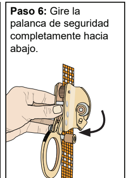
FIGURA 9 - INSTALACIÓN Y FUNCIONAMIENTO DEL AGARRADOR DE CUERDA DE EXTREMO LIBRE
