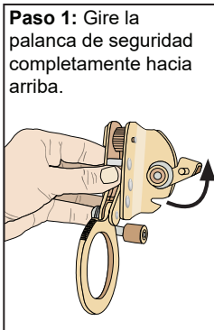
FIGURA 9 - INSTALACIÓN Y FUNCIONAMIENTO DEL AGARRADOR DE CUERDA DE EXTREMO LIBRE
