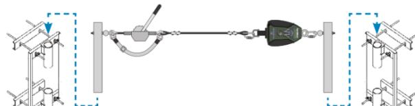
Fig. F. Abrazadera doble EZLink (FS-EX2502-DBL)
